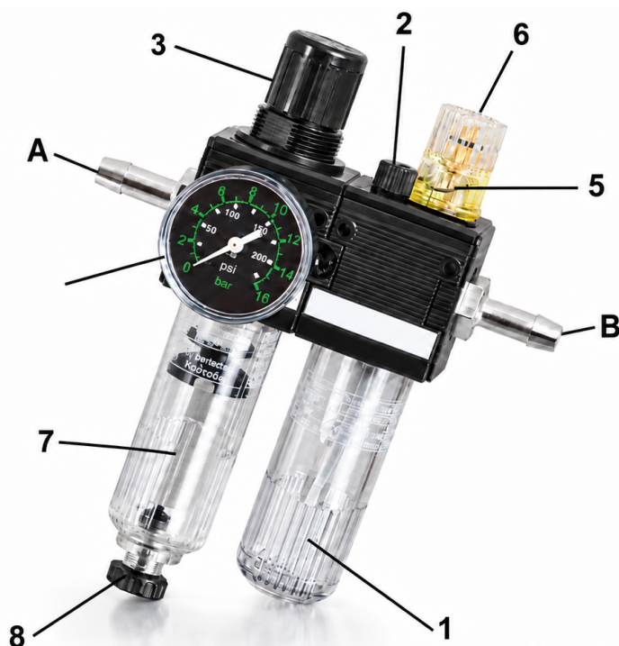
Figura 2: Exemplu de unitate de întreținere a aerului comprimat cu separator de apă, regulator de presiune și ungător. Presiunea de funcționare este afișată: 6,3 bar. Figura 2: A = Intrare aer comprimat; B = Ieșire aer comprimat către dispozitiv.
