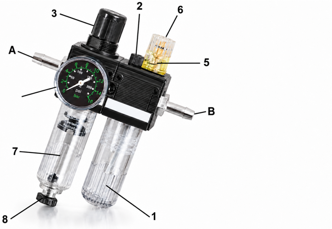
Figura 2 Esempio di gruppo di trattamento dell'aria compressa dotato di separatore d'acqua, regolatore di pressione e lubrificatore. Pressione di esercizio indicata: 6,3 bar. Figura 2: A = Ingresso aria compressa; B = Uscita aria compressa verso il dispositivo.
