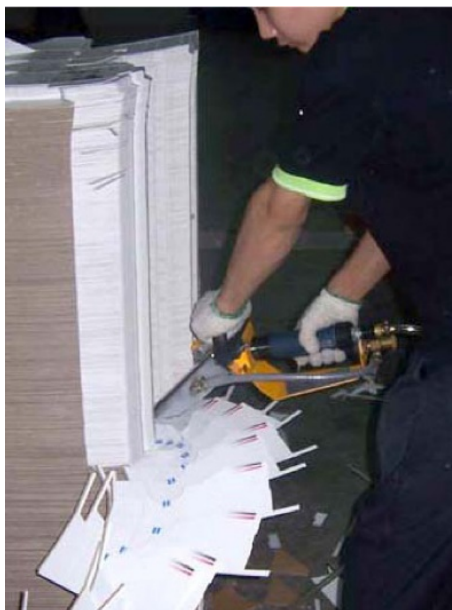
Figura 4: Ejemplo de una operación de desbroce en una pila
