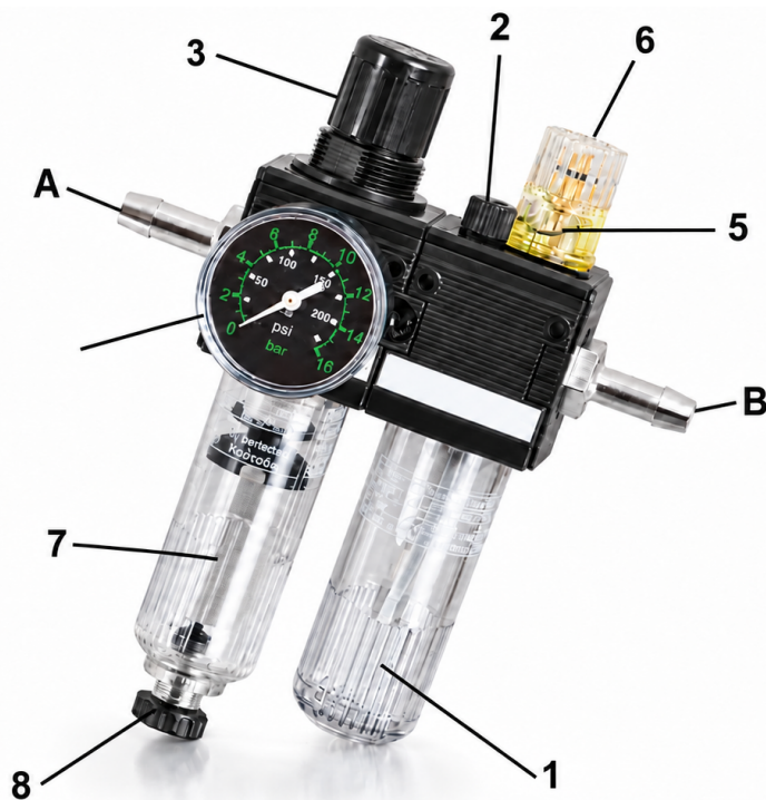
Σχήμα 2 Παράδειγμα μονάδας συντήρησης πεπιεσμένου αέρα με διαχωριστή νερού, ρυθμιστή πίεσης και λιπαντήρα. Εμφανιζόμενη πίεση λειτουργίας: 6,3 bar. Σχήμα 2: A = Είσοδος πεπιεσμένου αέρα. B = Έξοδος πεπιεσμένου αέρα προς τη συσκευή.
