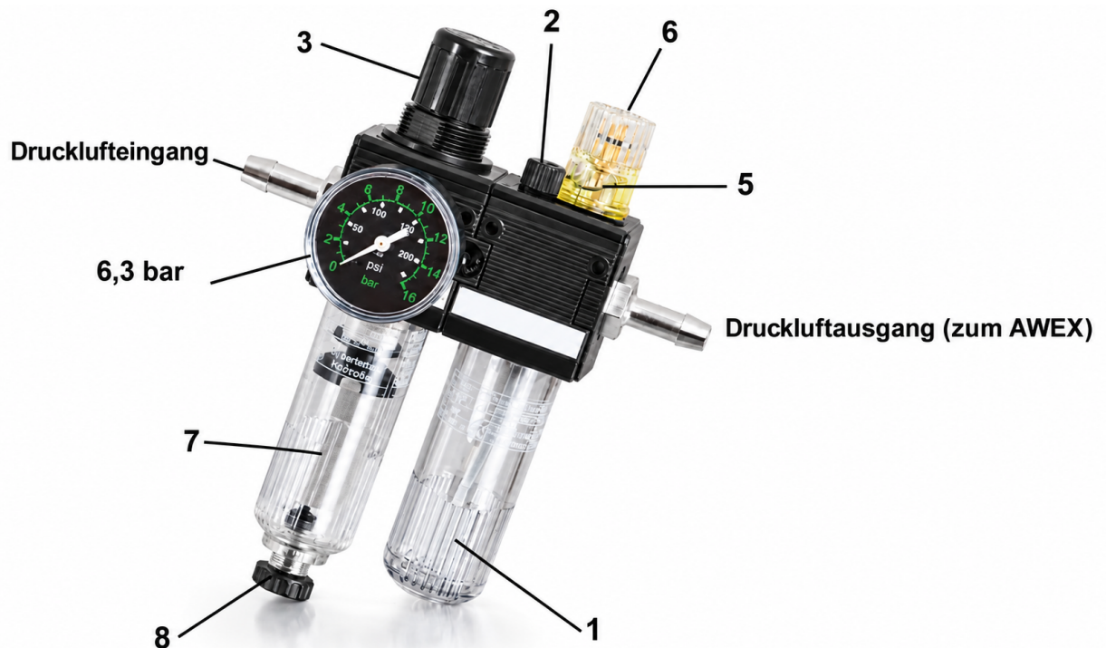
Abbildung 2 Beispiel einer Druckluft-Wartungseinheit mit Wasserabscheider, Druckregler und Öler. Abgebildeter Betriebsdruck: 6,3 bar.
