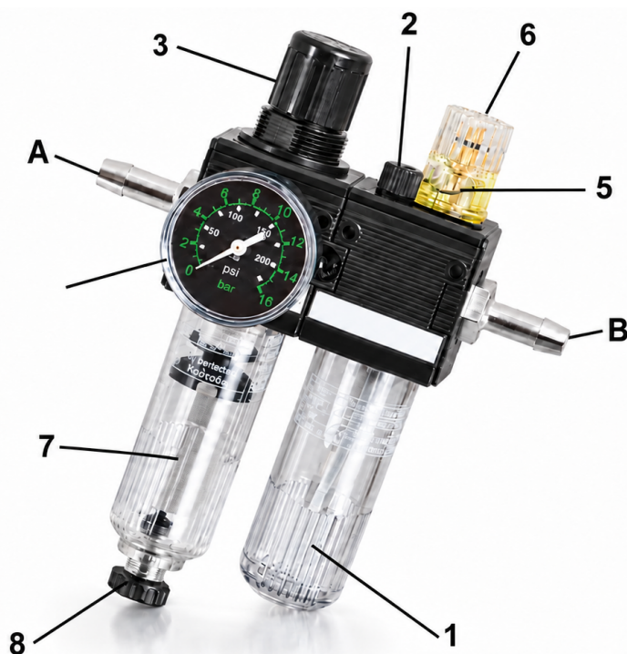
Obrázek 2: Příklad jednotky pro údržbu stlačeného vzduchu s odlučovačem vody, regulátorem tlaku a maznicí. Zobrazený provozní tlak: 6,3 baru. Obrázek 2: A = Vstup stlačeného vzduchu; B = Výstup stlačeného vzduchu k zařízení.
